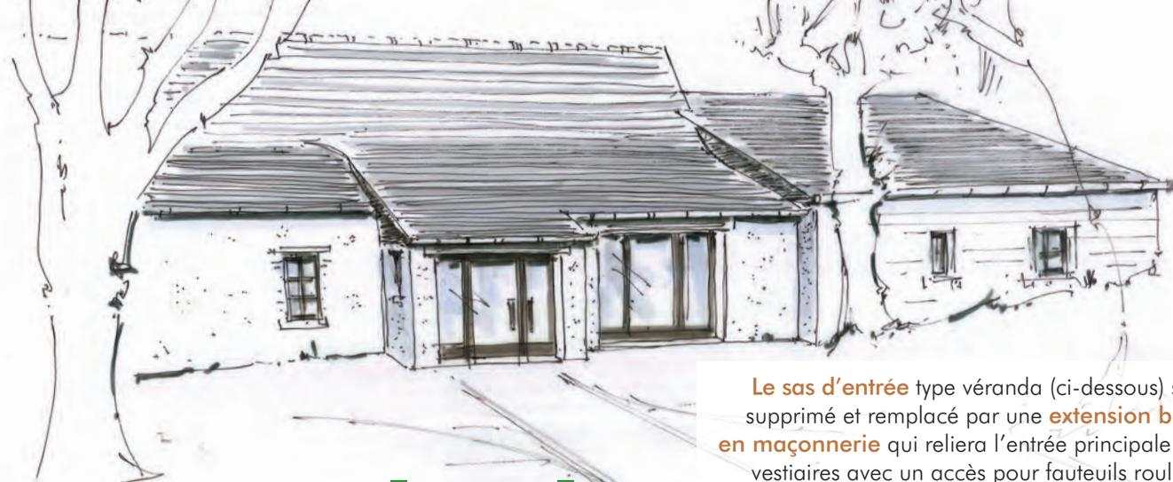
Le sas d'entrée type véranda (ci-dessous) sera supprimé et remplacé par une **extension bâtie en maçonnerie** qui reliera l'entrée principale aux vestiaires avec un accès pour fauteuils roulants
